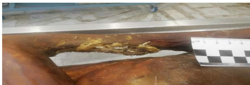
Рисунок 5. Повреждение на плече.
