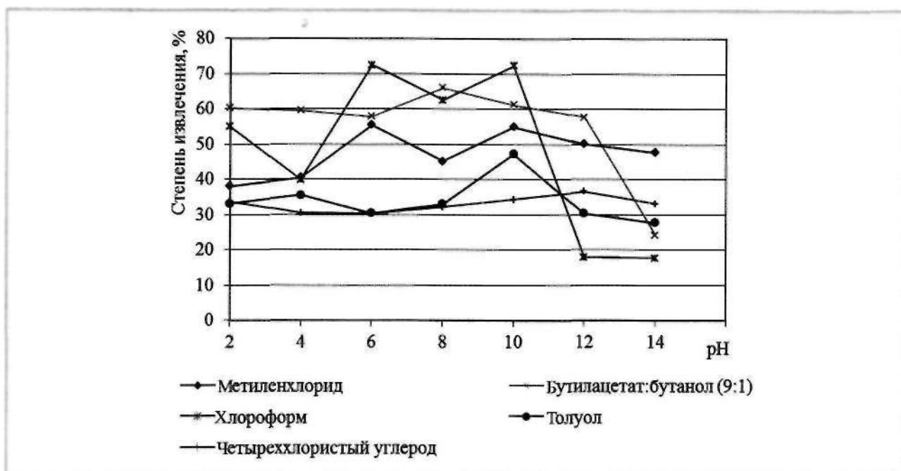
Рис. 1. Зависимость степени извлечения сертиндола от pH среды и природы органического растворителя.
