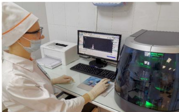
Рис. 2. Система капиллярного электрофореза МиниКап (Себия)
